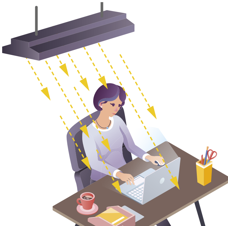
Figura 8. Orientación incorrecta en la que la luz incide por la espalda.
